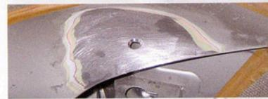
6 Verzinnete Teile mit der Karosseriefeile nacharbeiten und anschließend schleifen
