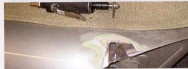
4 Bei tieferen Beschädigungen die Blechteile entfernen und erneuern.
