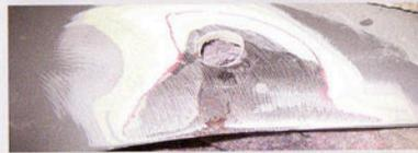
3 Schadstellen bei Unterrostungen bis aufs Blech herunterschleifen
