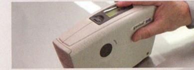
17 Mit Farbtonmessgerät ausmessen
