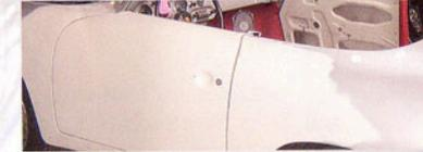
15 Füller planschleifen; unbeschädigte Decklackierung leicht anschleifen
